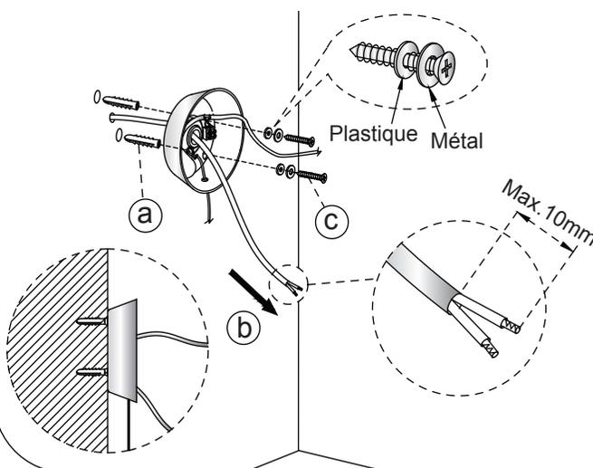
**3** Positionnez la base du luminaire en vous assurant que le fil ne soit pas coincé entre la base et la fixation murale. Serrez les deux vis sans tête sur la base.
