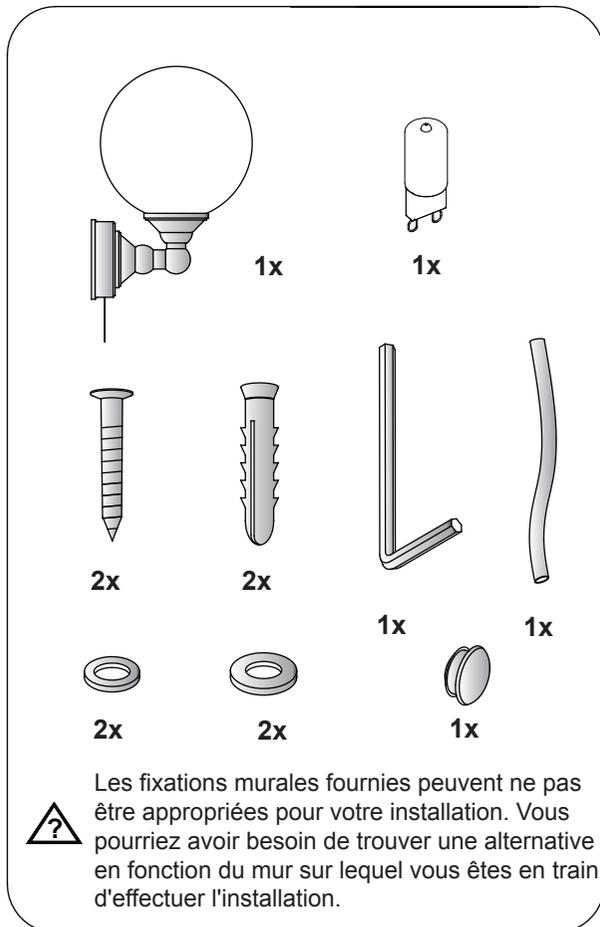
**1** Déterminer l'emplacement d'installation finale de la lumière, Desserrez les deux vis sans tête sur la base avec la clé Allen fournie et enlevez la fixation murale de la base. Avec le fil de tirette vers le bas, mettez la fixation murale contre le mur, marquez les positions des deux trous de fixations. Percez les trous au niveau des marques.
