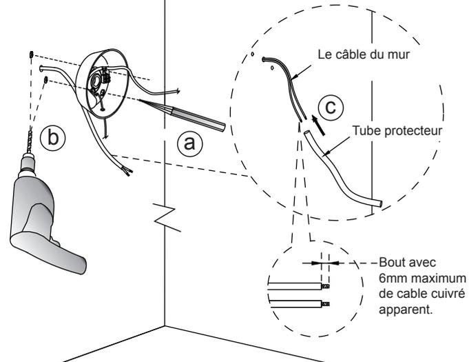
**2** Percez un oeillet au milieu de la fixation murale ronde et passez le tube de protection par l'oeillet. Fixez la fixation murale ronde au mur en utilisant les vis fournies.
