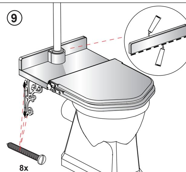
Repositionnez le siège contre le mur, alignez les trous des ornements avec les trous prépercés sur le mur, fixez dans le mur en serrant les vis fournies. Finalement attachez la planche au mur et au siège en utilisant du mastic approprié pour le bois et les surfaces carrelées.
