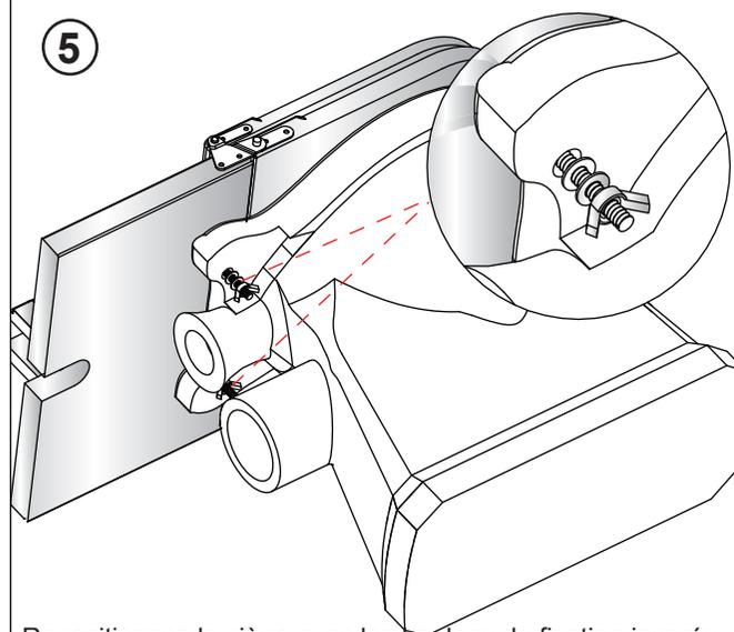
Repositionnez le siège avec les boulons de fixation insérés dans les trous de la cuvette. Assurez vous que la position est bonne et fixez sur la cuvette en glissant dans l'ordre le joint en caoutchouc, le joint en laiton et finalement serrez avec l'écrou.
