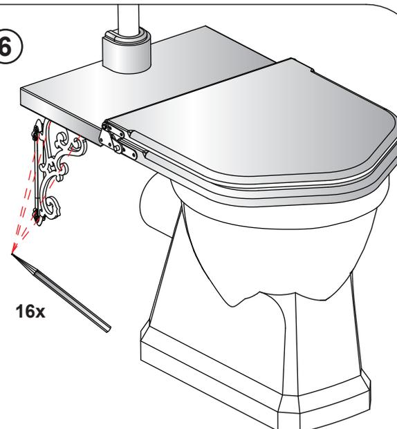
Placez l'ornement dans la bonne position. Marquez la position des trous de fixation sur le mur et sur le siège avec un crayon.
