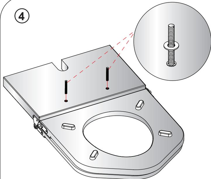
Vissez les boulons de fixation dans leurs têtes et glissez les joints sur les boulons.
