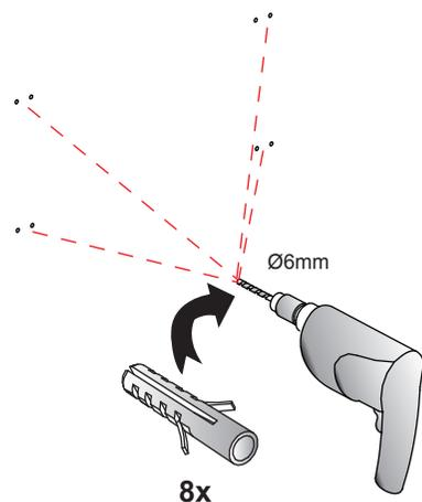
Percez les trous en utilisant une perceuse de 6mm en suivant les marques et insérez les chevilles dans le mur. (NOTE: Dans le cas où les fixations ne sont pas adaptées à votre mur, veuillez trouver une source alternative).
