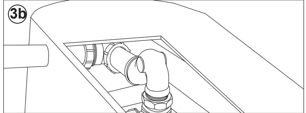
Méthode 2) Si l'accès au sous-sol est impossible, un trou additionnel d'approximativement 45mm de diamètre peut être percé à travers la paroi externe de la baignoire pour connecter le trou d'évacuation à un tuyau rigide.
