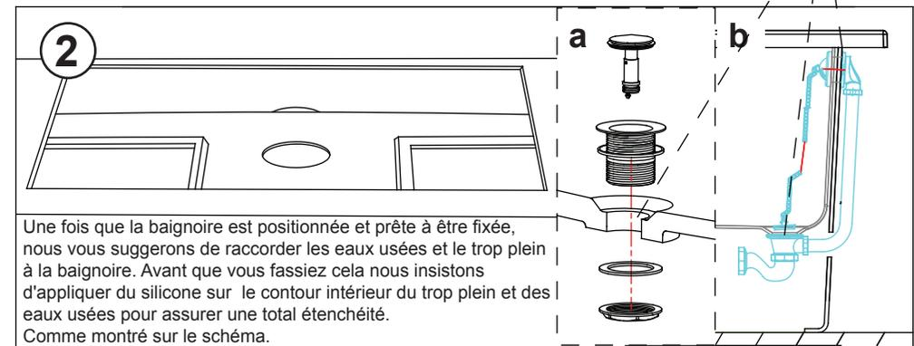
Une fois que la baignoire est positionnée et prête à être fixée, nous vous suggérons de raccorder les eaux usées et le trop plein à la baignoire. Avant que vous fassiez cela nous insistons d'appliquer du silicone sur le contour intérieur du trop plein et des eaux usées pour assurer une total étanchéité. Comme montré sur le schéma.
