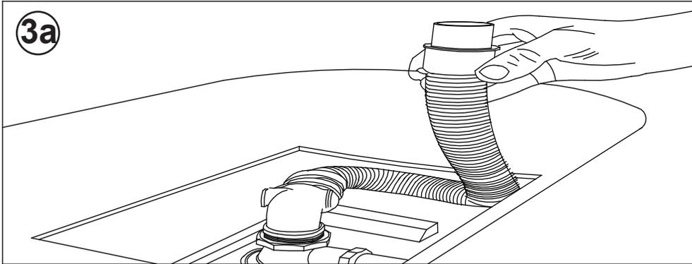
Méthode 1) Si vous avez la baignoire dans la position nécessaire. Pour éviter la rétention d'eau dans le trou, la tuyau flexible doit avoir un flot descendant continu.
