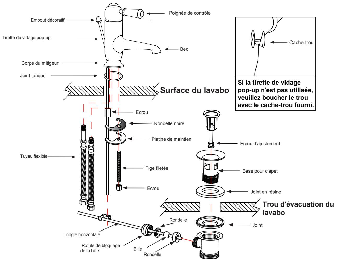
1. Insérez le joint torique dans la rainure dans la partie inférieure du corps du mitigeur.
