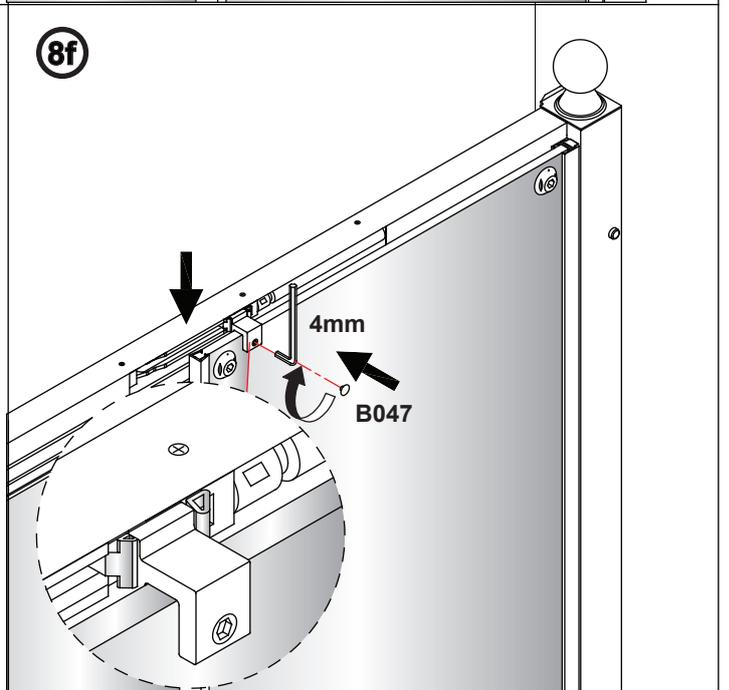
Verifiez que la porte est bien fermée et qu'il n'y a pas d'espace. Comme indiqué sur le schéma entre les clips du mécanisme placez la prise par dessus la vitre, et serrez sur la vitre.
