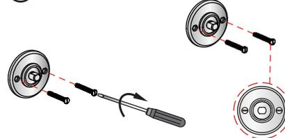
Utilisez un tournevis plat et les vis en acier inoxydable pour fixer la base au mur. Veuillez vous assurer que les fentes sur les têtes de vis sont bien horizontales.
