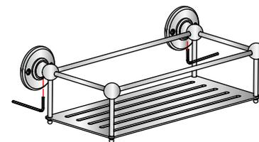
Insérez le corps de l'accessoire dans la base et fixer-le en utilisant la clé hexagonale fournie.
