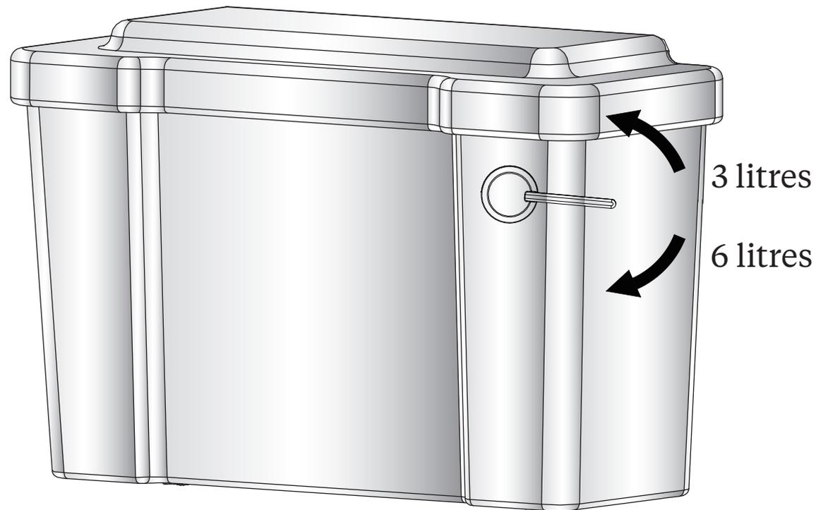
Veillez noter qu'il est impératif qu'il n'y a pas de boucles ou de plis dans le tube jaune lorsqu'il est installé et que le levier ne fonctionne pas avec une force excessive car cela endommagerait le câble à l'intérieur du tube qui soulève et abaisse la valve de chasse provoquant une panne de la chasse au-delà de la réparation.
