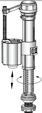
Desserrez la valve d'admission en tournant légèrement en sens inverse des aiguilles d'une montre. Ajustez-le vers le haut ou le bas la position et revisser dans le sens des aiguilles d'une montre.
