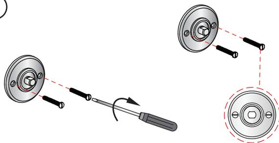
Fixez la base au mur en utilisant les vis en acier inoxydable. Veuillez vous assurer que la tête des vis soit parallèle au sol.
