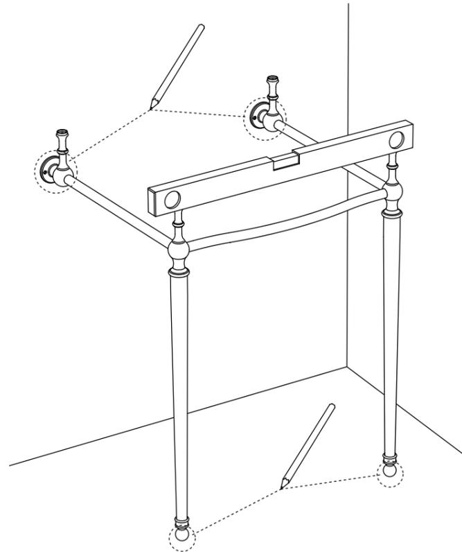
**8** Percez 6 trous aux emplacements marqués en utilisant une mèche de 6,35 mm.
