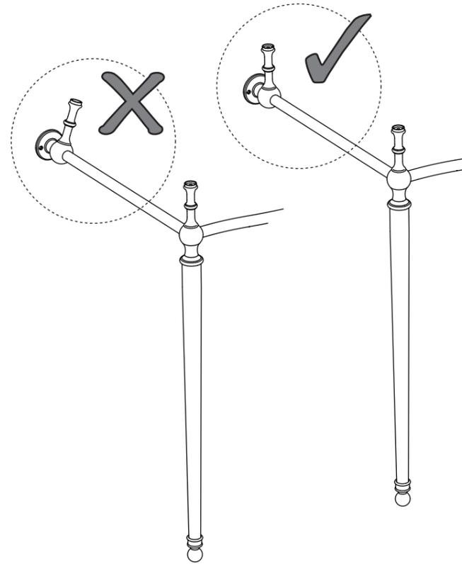
**7** Déterminez l'emplacement final et marquez la position des 4 trous de fixation au mur et des 2 trous de fixation au sol avec un crayon. Assurez-vous d'inclure les patins (et les rondelles, si nécessaire) lors du positionnement puisque la hauteur du piétement peut augmenter une fois les patins sont ajoutés.
