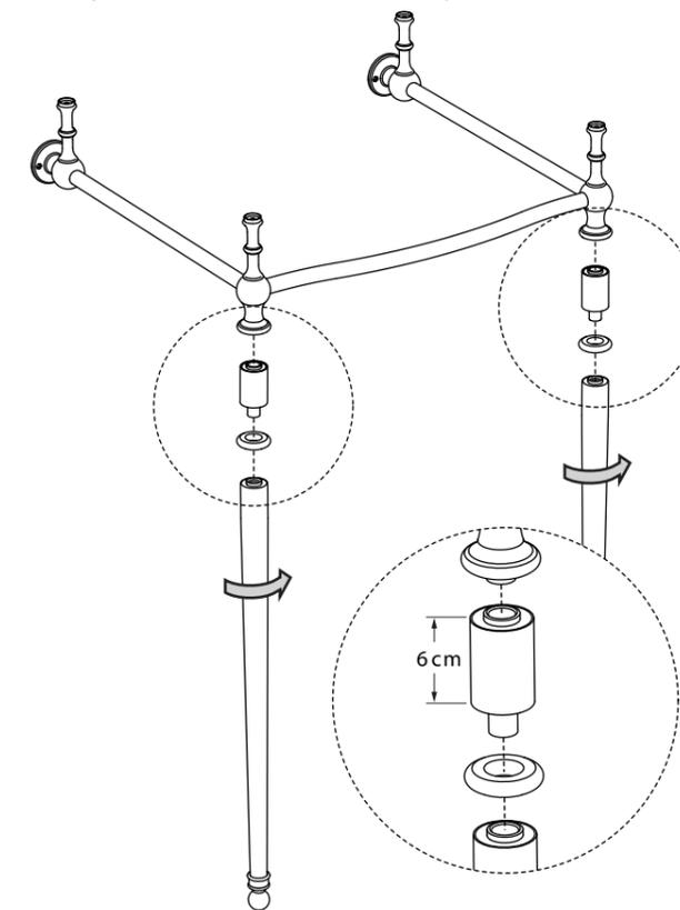
**6** Vérifiez que les barres de maintien verticales sont bien à niveau en utilisant un niveau à bulle.
