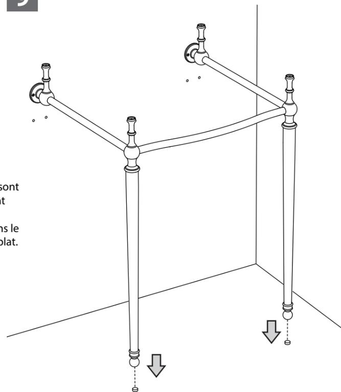
**10** Vissez les deux fixations murales au mur en utilisant les 4 vis fournies. Assurez-vous que les têtes de vis sont parallèles au sol. Placez les 4 rondelles en caoutchouc dans les creux des barres de soutien comme montré ci-dessous.
