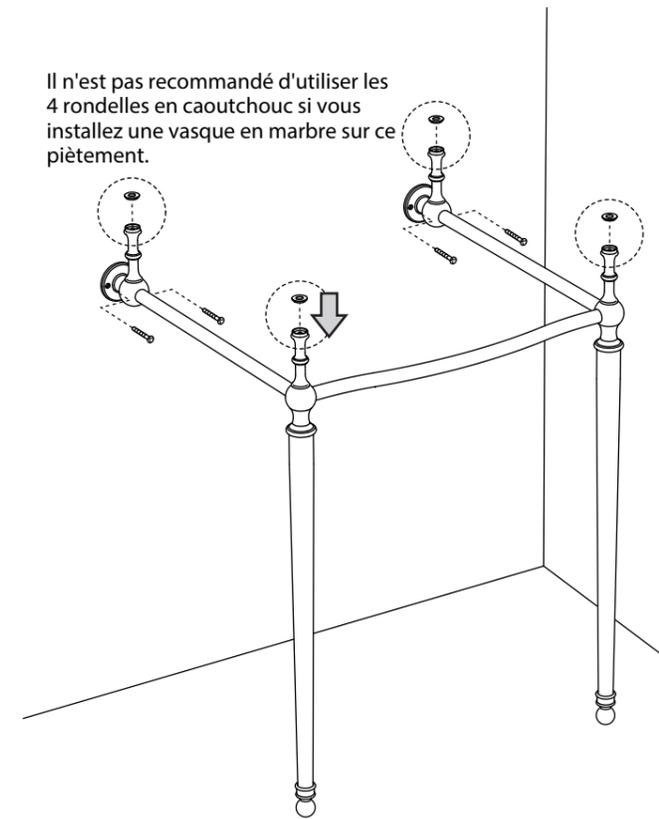
**11** Si vous installez une vasque en céramique, placez la vasque en position en vous assurant qu'elle soit à niveau. La vasque doit être fixée au mur à l'arrière avec des fixations appropriées.
