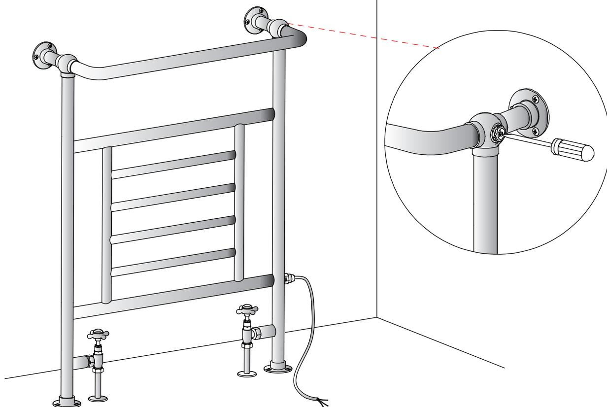
Raccordez le radiateur au circuit électrique via le boîtier à fusible. Vérifiez qu'il n'y ait pas de fuites. Suivez les instructions d'installation fournies avec le kit de chauffage électrique d'été. Tout le travail électrique doit être fait par une personne qualifiée.
